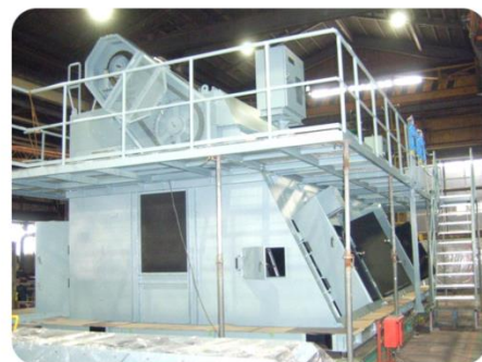
水処理場向／沈砂掻揚機
